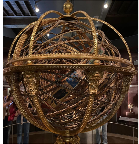
Sfera armillare di Santucci. Usata per rappresentare il movimento dei pianeti intorno alla Terra
